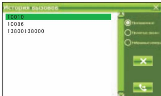
Выберите “Пропущенные”, “Принятые звонки” либо “Набранные номера” для просмотра соответствующего списка вызовов.
