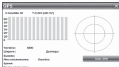
Для нормальной работы устройства необходимо, чтобы навигатор считал информацию с 4х спутников. На экране состояния (на «глобусе») эти спутники будут засвечены зеленым цветом. Если этого не происходит, это означает отсутствие сигнала от спутников по причине плохого приема (высокая облачность, стоящие рядом здания и пр.). В некоторых случаях Может помочь перезагрузка GPS приемника, совершаемая нажатием иконки «Обновить GPS».
