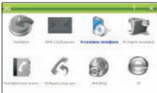
Для включения GPRS модема нажмите кнопку “Установка телефона”
