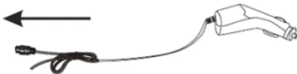
**Примечание:** зарядка может осуществляться параллельно видеосъемке, а также при отключенном видеореги­страторе. В процессе зарядки средний LED-индикатор светится непрерывно красным.
